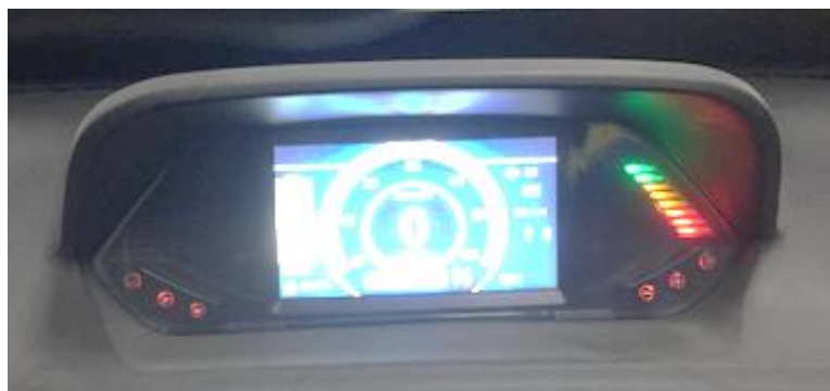
Рисунок 36 – Индикатор заряда АБ электромобиля
