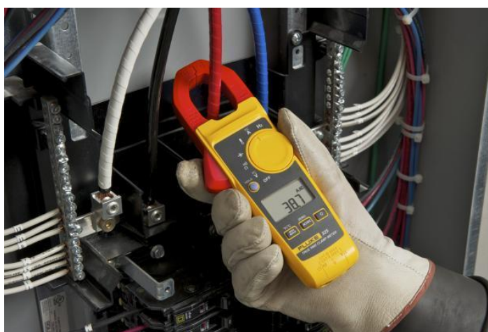
Рисунок 37– Схема замера пускового тока цифровыми клещами
