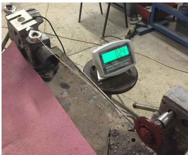
Рисунок 30 - Момент фиксации крутящего момента (3-я позиция регулятора мощности)
