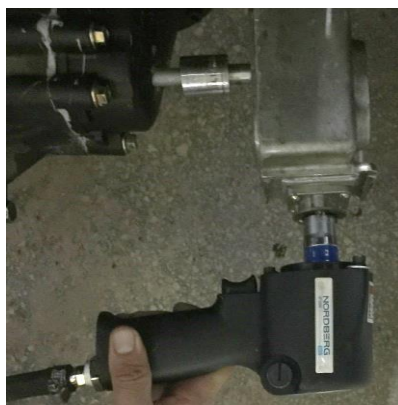
Рисунок 22 – Общий вид вспомогательного пневмопривода с промежуточным редуктором
