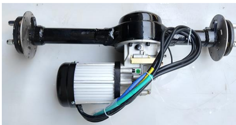
Рисунок 2 – Устройство заднего моста электромобиля
