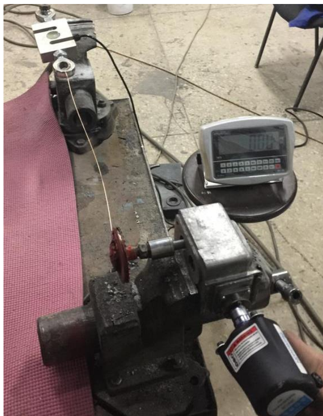
Рисунок 29 – Схема замера крутящего момента создаваемого стартовым устройством с подключенным пневмомотором.
